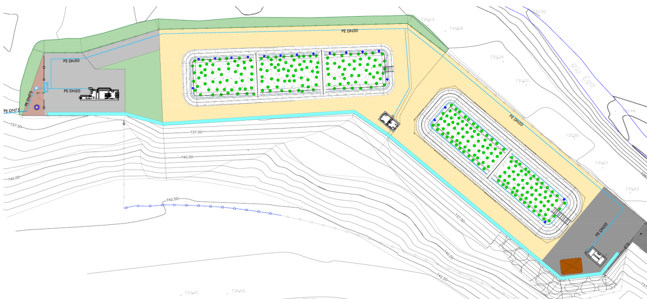
Red proyectada de abastecimiento de agua potable en color cian
